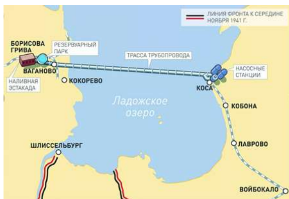
Рис. 10 Схема проложенного трубопровода для горючего по дну Ладоги
