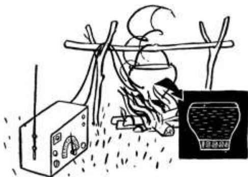
Рис. 3 Котелок с термоэлектрическим генератором
